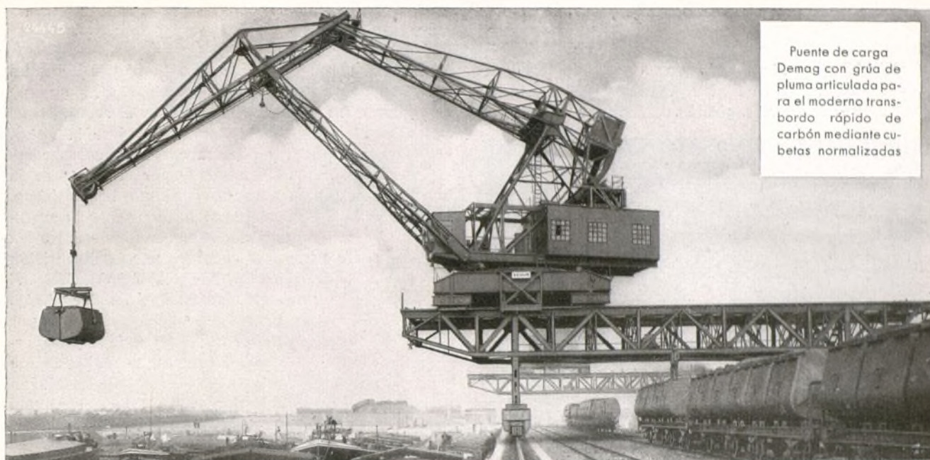
Puente de carga Demag para carbón y coque, con grúa de pluma articulada, cintas transportadoras, criba y distribuidores ya montados
