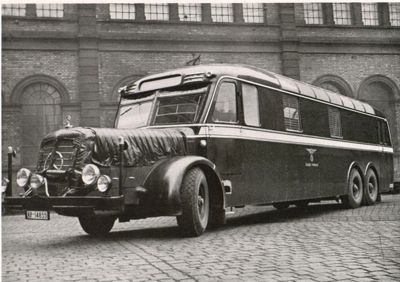
Tipo de los nuevos coches que usan los Correos alemanes para transportar correspondencia y encomiendas a lugares apartados. A pesar de su largo de 14 m., este coche desarrolla una velocidad de hasta 90 kms./hora
