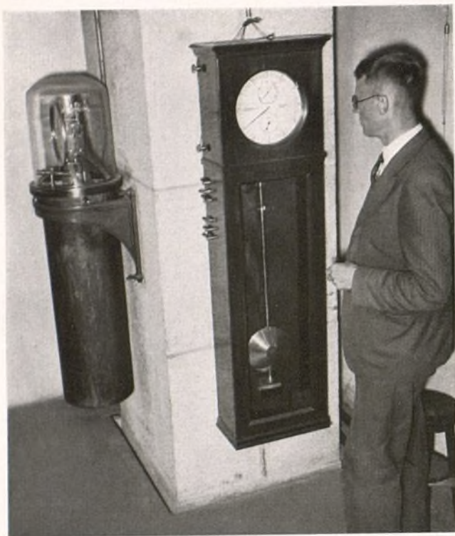
Para conservar la hora exacta en los relojes de precisión del Observatorio, éstos se hallan colgados en un macizo zócalo de hormigón armado
