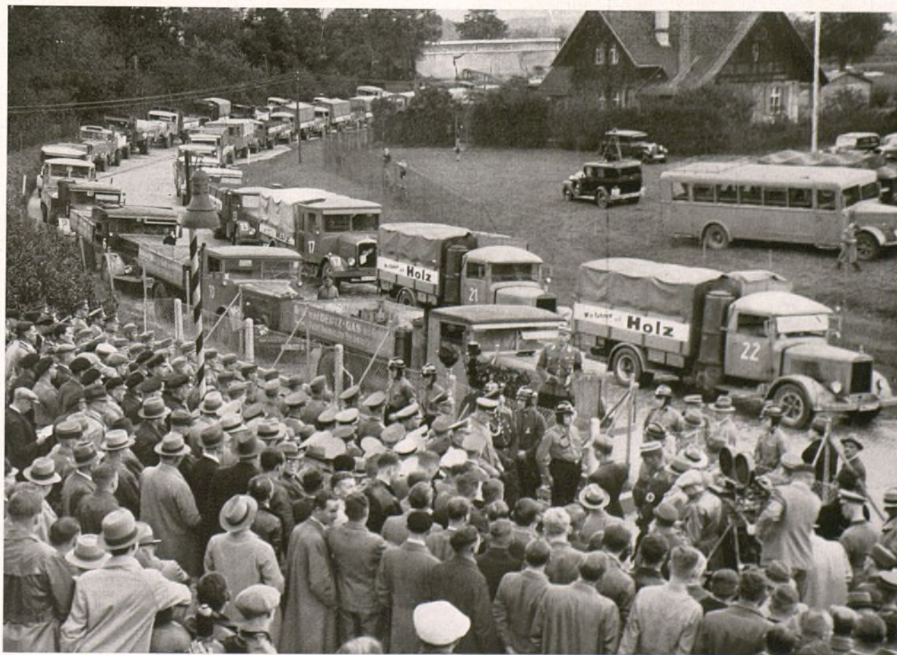
Autocamiones con motor a gas de madera en un recorrido de prueba cerca de Berlín
