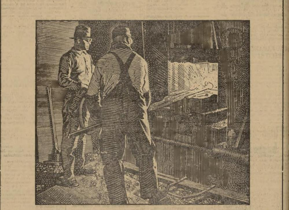
Una escena de la planta de fundición del Chevrolet. Forjando un eje del frente de una barra de magnifíco acero ligado.
