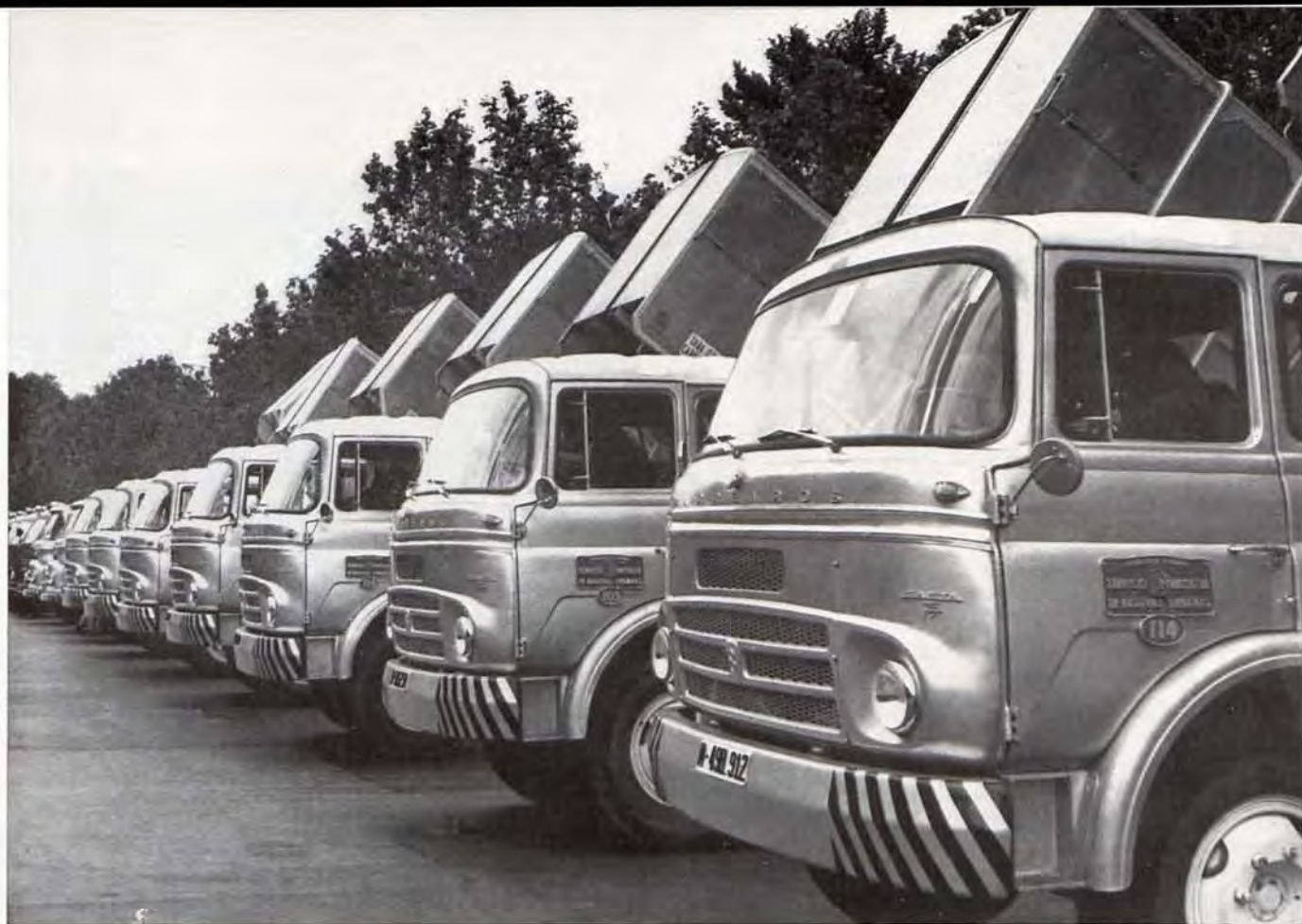
Plan de modernización del Servicio de Limpiezas: camiones colectores con caja de compresión.
