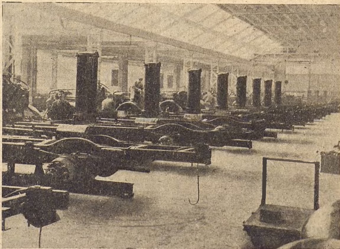
Fabricación en serie de camiones movidos con gas de madera con generador Imbert en los talleres Saurer, de Viena.
