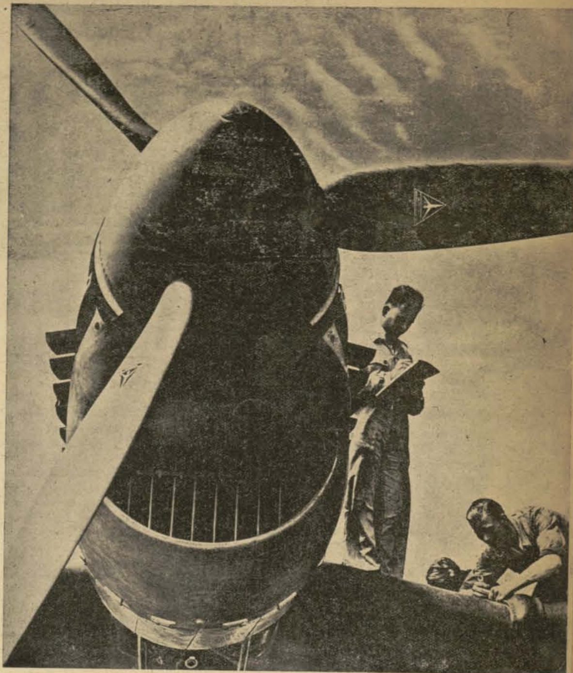
Este avión es tripulado por una persona, y se lanza desde 8-9.000 metros con una velocidad en caída de 800 kilómetros-hora, con su bomba o torpedo, sobre el objetivo. En una altura de aproximadamente 500 metros, la bomba se desprende, y el mecanismo de guía levanta al avión automáticamente.
