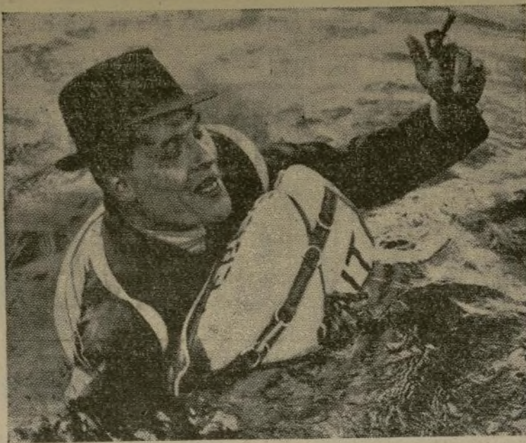
Un hombre probando el nuevo asiento inflable instalado en los hidroaviones de la Imperial Airways de Gran Bretaña, continúa fumando su cigarro mientras flota. Los cojines, que pesan 5 libras y pueden soportar 280 libras en el agua, pueden convertirse en cinturones salvavidas en unos cuantos minutos.
