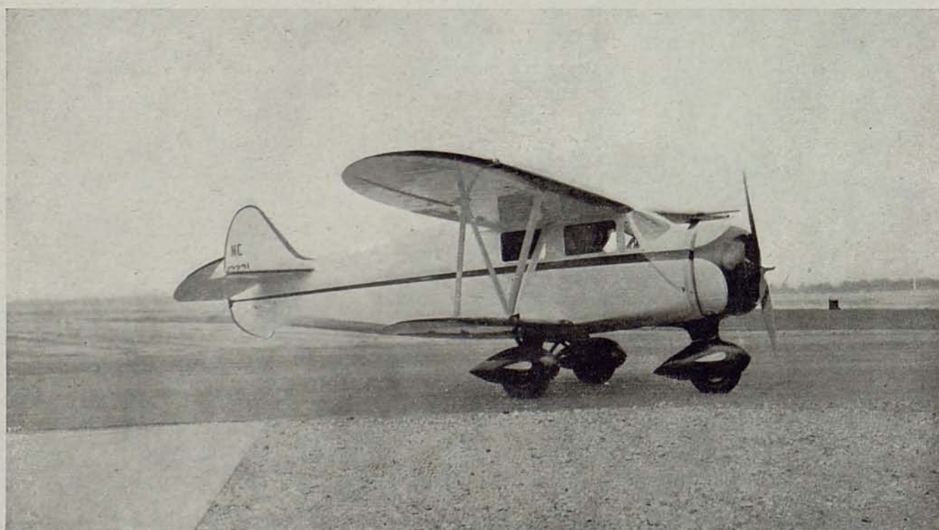
La idea del triciclo se generaliza, y así vemos el avión "Waco" de carreras provisto también de este nuevo tipo de tren de aterrizaje
