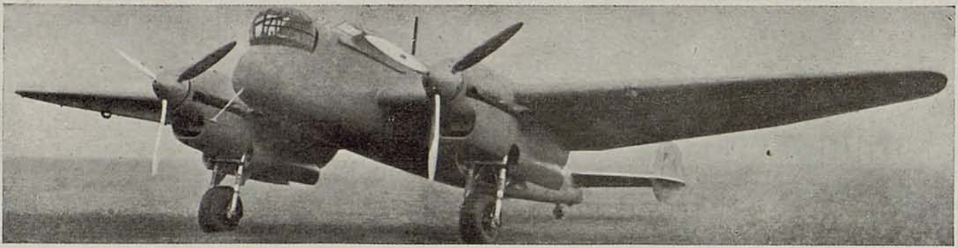
Bimotor alemán de combate Henschel "He-124" con tren de aterrizaje replegable
