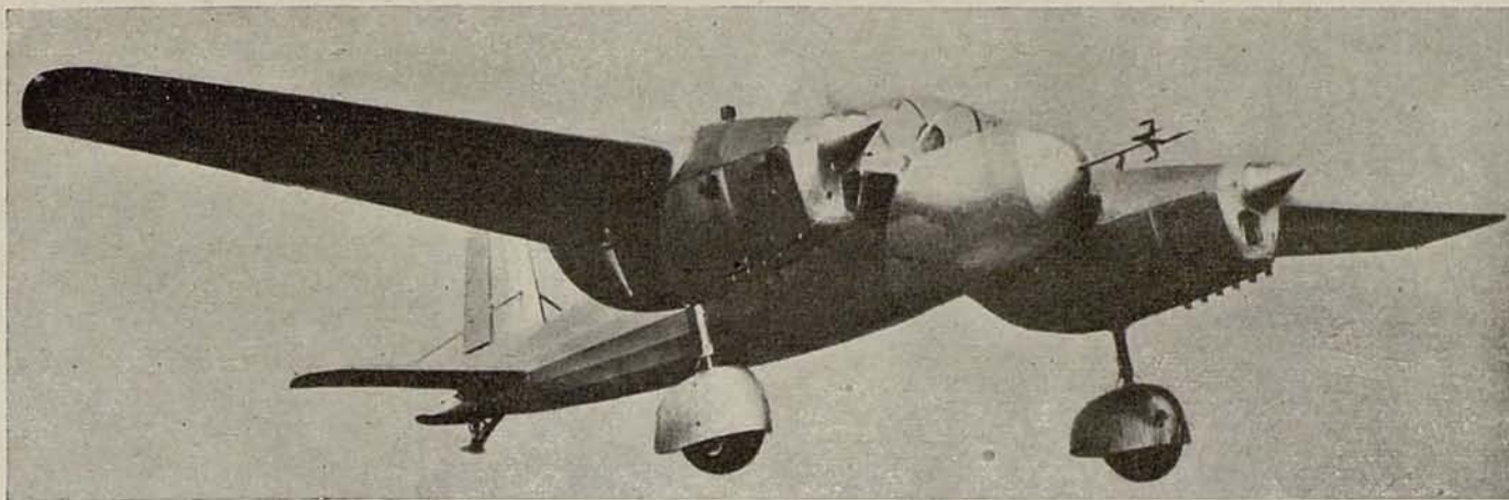
Bimotor francés de escuela y entrenamiento Hanriot-"230" con motores Salmson de 180 cv.
