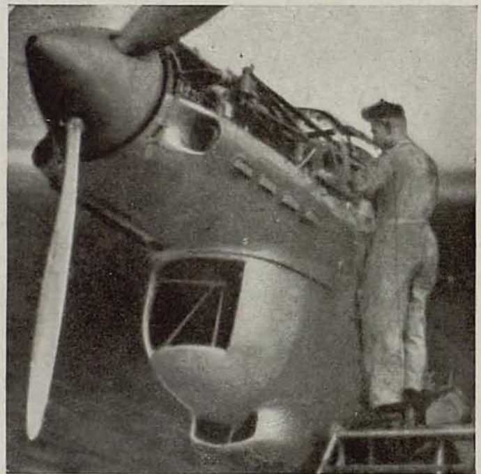
Detalle de los motores de aceites pesados Jumo "211" montados en muchos aviones de bombardeo alemanes
