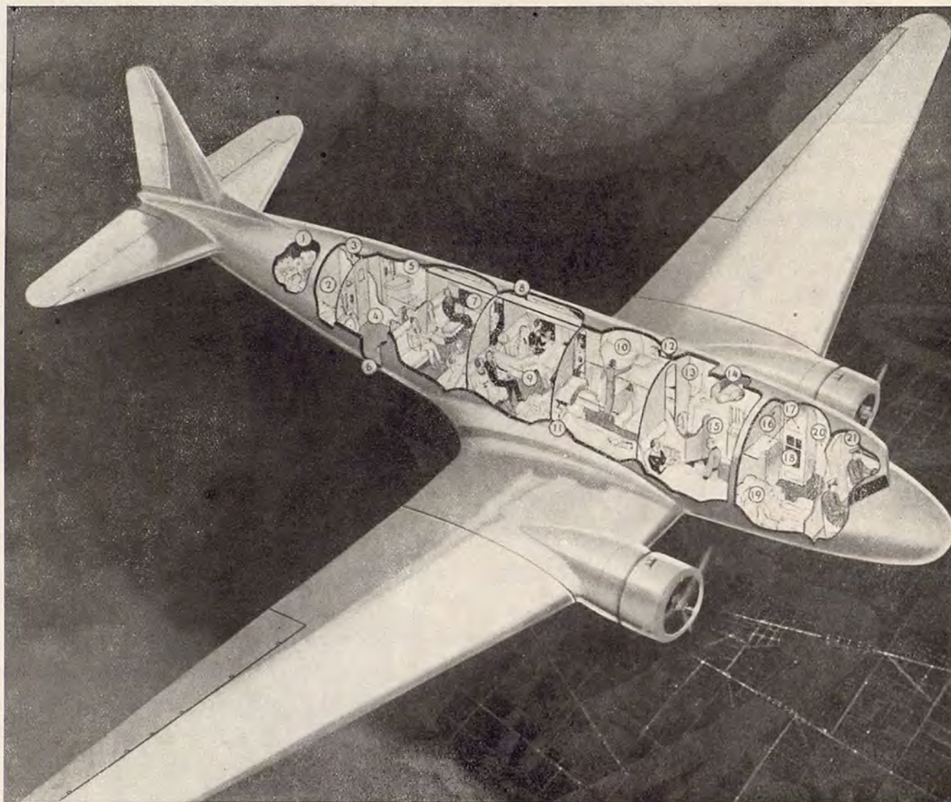
DOUGLAS D. S. T.—1, Departamento de equipajes.—2, W. C. para hombres.—3, W. C. para señoras.—4, Lavabo para hombres.—5, Tocador para señoras.—6, Puerta al exterior.—7, Tres cabinas para 8 plazas o 4 camas, haciendo un total de 24 plazas o 12 camas.—8, Posición de las camas de día.—9, Cada asiento lleva una ventanilla individual, ventilador, luz para leer y mesa portátil. Los sillones se pueden ajustar en tres posiciones distintas.—10, Cada cama tiene mecanismo de ventilación individual.—11, Los respaldos de las butacas de noche se aplican para dejar las ropas.—12, Cada cama superior cuenta con ventanilla para ventilación, luz para leer y timbre de llamada a la camarera.—13, Cocina.—14, Departamento para carga y pasillo de comunicación a la cabina de pilotaje.—15, Departamento para dos plazas privado con lavabo y toilet completa, totalmente independiente.—16, Puerta del pasillo de comunicación.—17, Departamento de radio.—18, Puerta del departamento de carga.—19, Departamento de correos.—20, Puerta al exterior.—21, Departamento de pilotaje.
