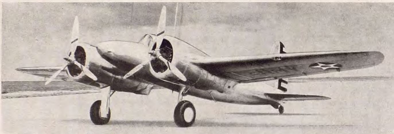
Avión de asalto «Curtiss Y-1-A», con motores Wright Cyclone de 1.000 HP. del cual las Fuerzas Aéreas Norteamericanas han ordenado su construcción en gran número
