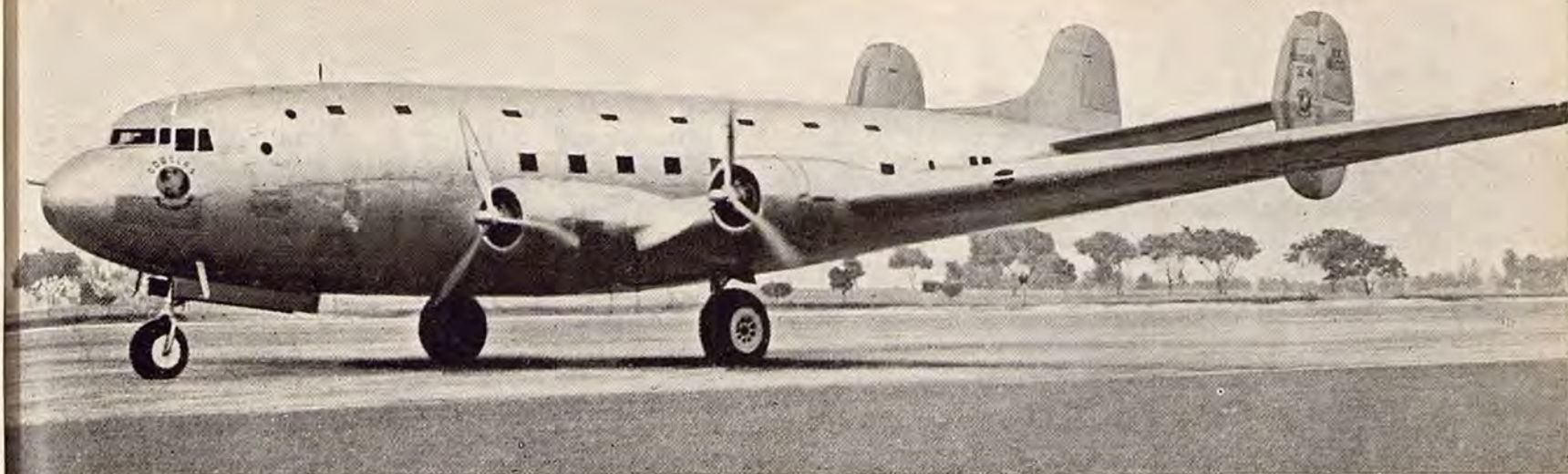
El Douglas DC-4 para 42 pasajeros, equipado con hélices Hamilton Standard Hydromatic
