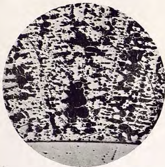
Fig. 5.—Microfotografía de un cupro-plomo en la que aparece el cobre con formación dendrítica pero aún con puntos de plomo segregado. 115 aumentos.
