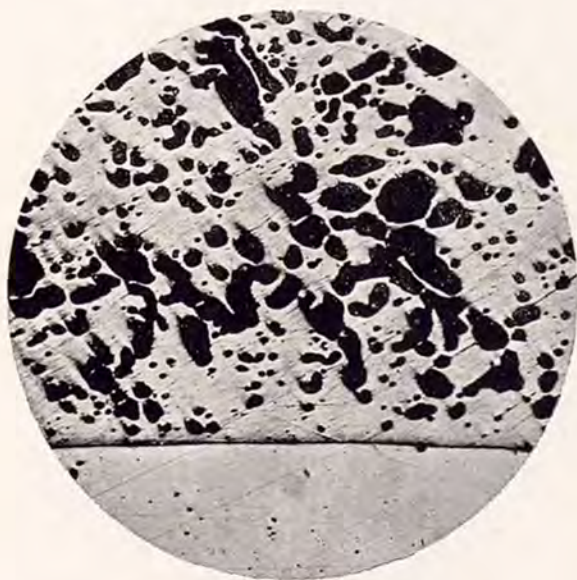
Fig. 3.—Microfotografía en la que aparece el cupro-plomo con segregaciones de plomo menos importantes que en la figura anterior, y sin estructura dendrítica. 115 aumentos.
