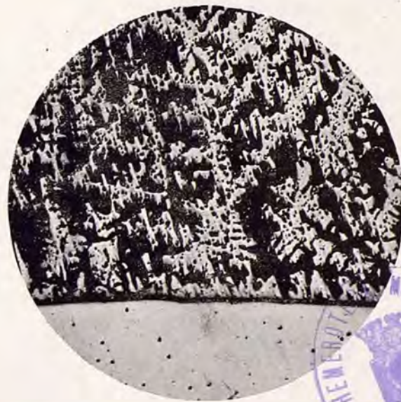
Fig. 8.—Correcta microestructura de un cojinete de cupro-plomo en la que aparece una fina matriz de cobre dendrítico ideal para los cojinetes de cupro-plomo de motor de Aviación. 115 aumentos.
