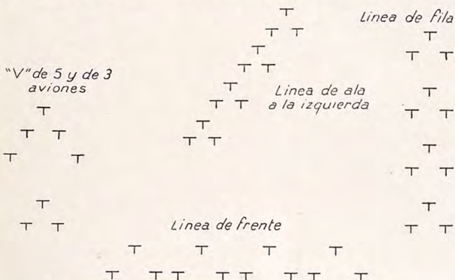
Fig. 1.—Esquemas de las principales formaciones en vuelo citadas por el autor
