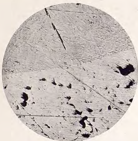
Fig. 1.—Micrografía mostrando la perfecta unión del bronce al plomo con el soporte de acero. El bronce ha disuelto parte del acero para soldarse formando una unión cobre-hierro indistinguible. 115 aumentos.
