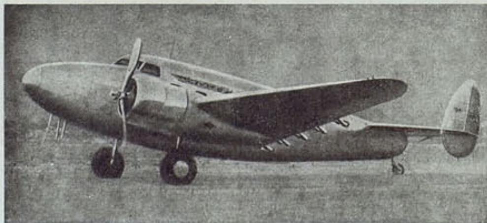
El "New-York World's Fair" - "Lockheed 14", equipado con dos motores Wright "Cyclone", de 1.100 c.v.
