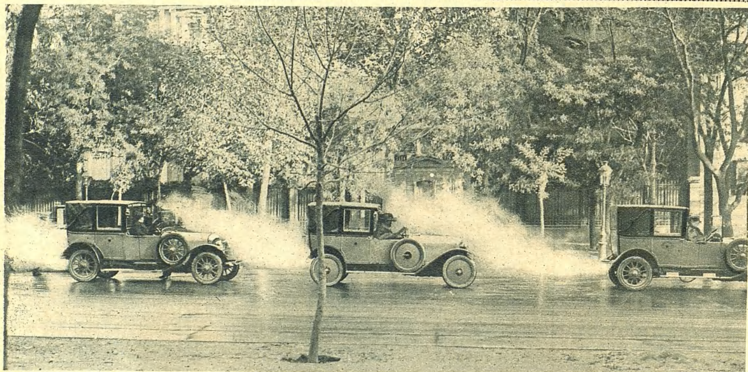
El escape horizontal actual es perjudicialísimo para el peatón y el conductor que viene detrás, forzados á respirar los gases de óxido de carbono de los que ruedan delante
