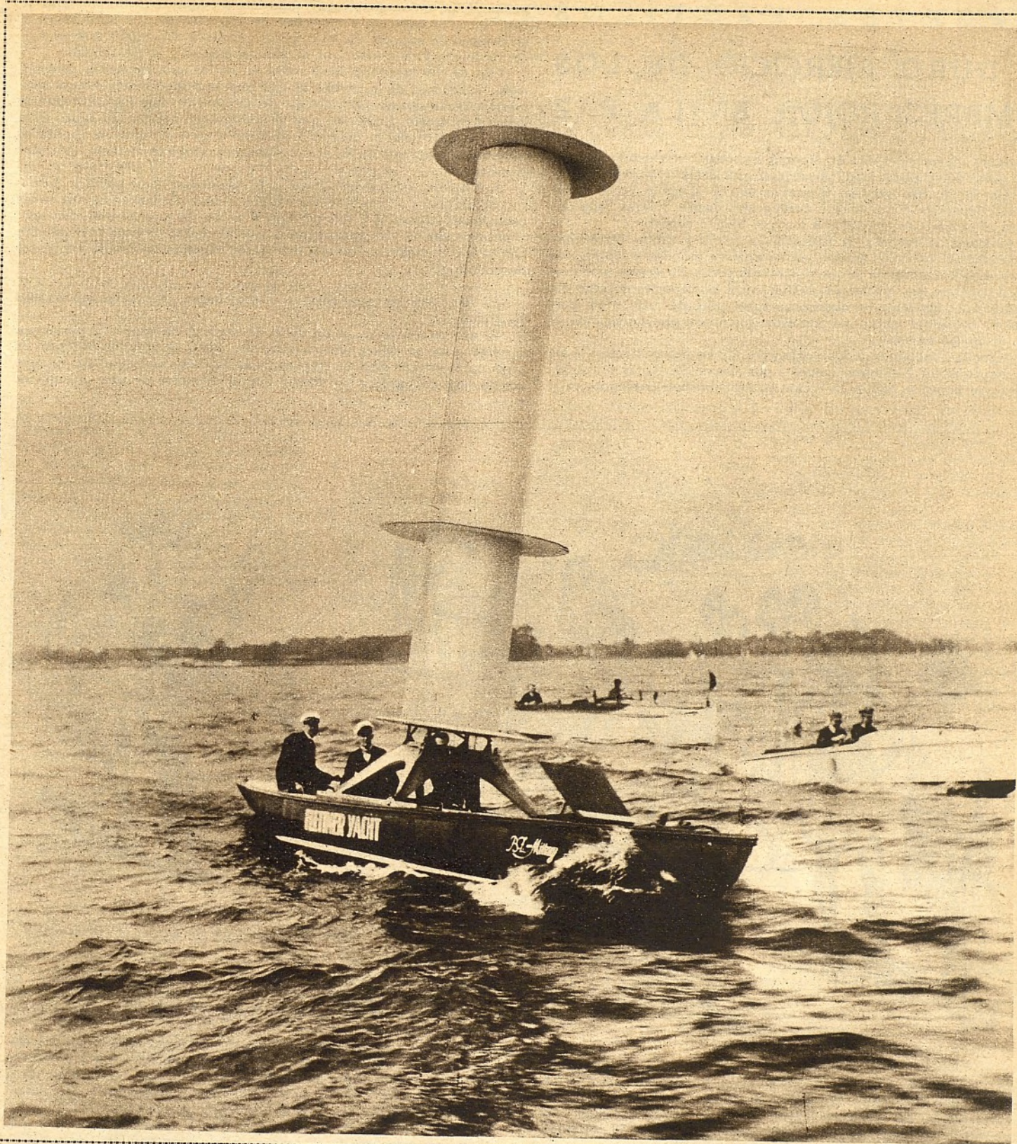
El rotaotrio de Flettner también da popa á dos balandros que, á un viento favorable, son dejados atrás por la nueva extraña embarcación FOTS. MARIN
