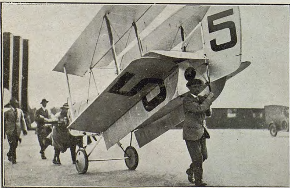
Uno de los aparatos que han volado en Lympne saliendo del cobertizo, plegado y llevado por el piloto únicamente
