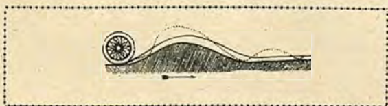
Fig. 2.ª—En este diseño se indican las trayectorias de una rueda con ó sin amortiguador: la línea de puntos indica la sin amortiguador
