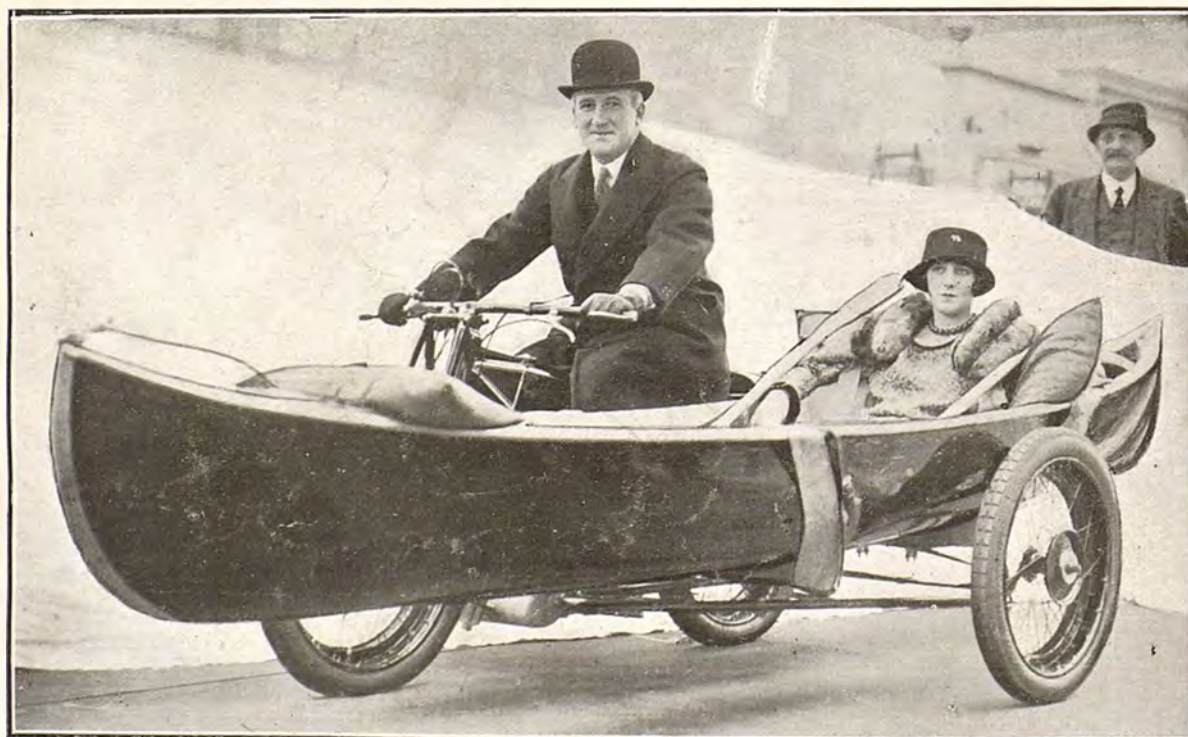
La motocicleta con sidecar desmontable que, provisto de remos, puede navegar fácilmente llegado el caso FOTS. G. L. Y AGENCIA GRÁFICA
