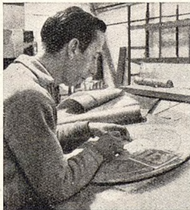
El método más simple de preparar una plantilla es colocar papel de calcar sobre el dibujo y recortarlo a mano. Muy a menudo se usa también una hoja de papel cristal cubierta con laca o barniz, recortando luego solamente esta capa, dejando intacto el papel, que forma un soporte hasta que se une a la pantalla.
