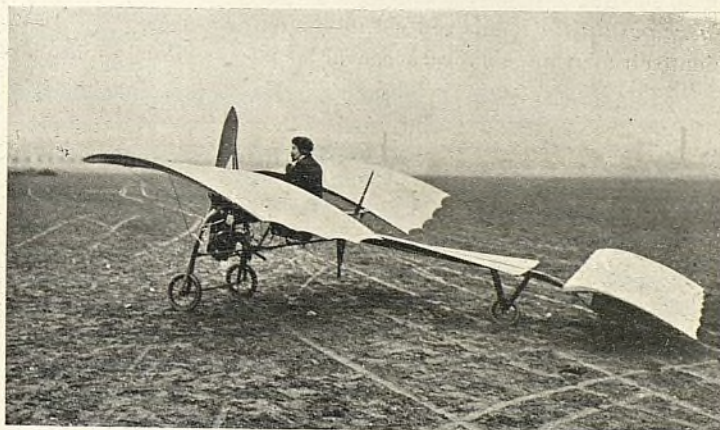
Monoplano «Raul Vendôme». — El más pequeño, ligero y rápido del mundo. — Superficie, 7'80 metros. — Envergadura, 5 metros. — Largo, 5 metros. — Peso, 86 kilos. Motor Anzani de 3 cilindros, 12 HP.
