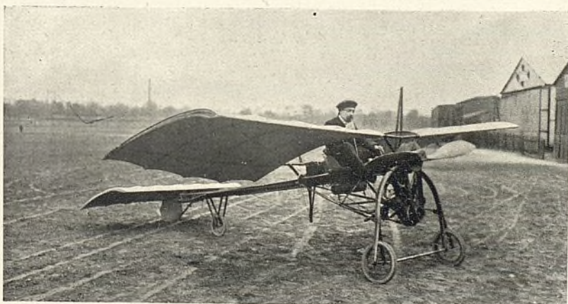
Monoplano «Raul Vendôme». — El más pequeño, ligero y rápido del mundo. — Superficie, 7'80 metros. — Envergadura, 5 metros. — Largo, 5 metros. — Peso, 86 kilos. Motor Anzani de 3 cilindros, 12 HP.
