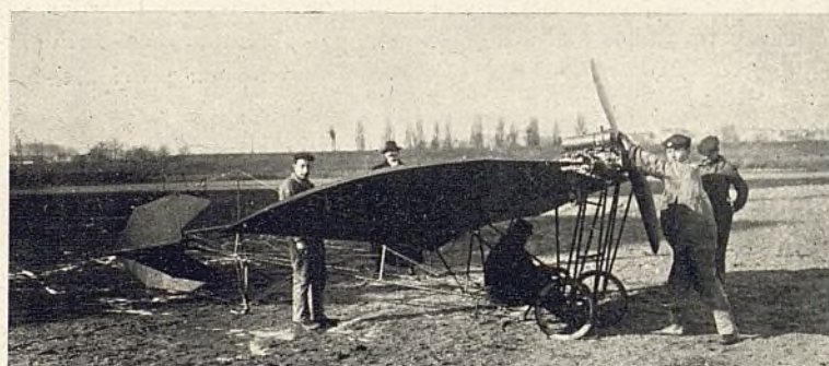
Monoplano «Demoiselle» de Clément-Bayard, tipo Santos Dumont, con motor Clément 2 cilindros 30 HP., pilotado por M. Mauricio Clément
