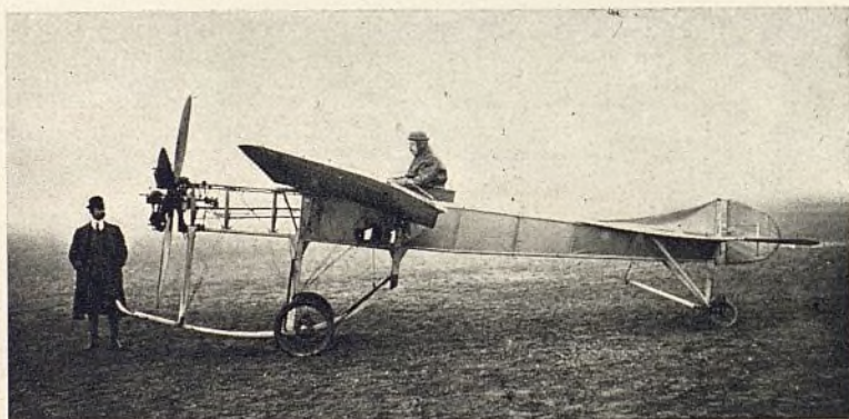
Monoplano «Taris», pilotado por M. Paul de Lesseps. — Superficie, 14 m 2 . — Envergadura, 8'5 metros. — Peso en orden de marcha, para una hora 350 kilos Hélice de cuatro palas sistema Taris
