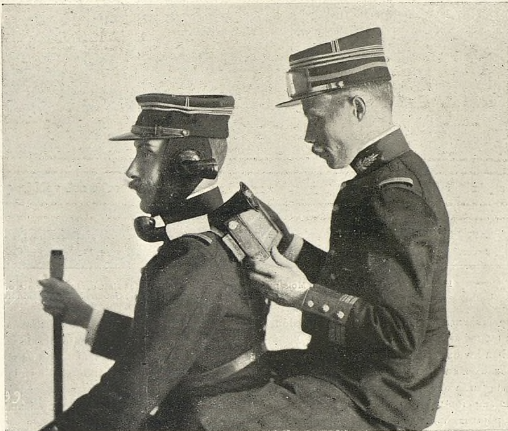
El micrófono inventado por el capitán Marconnet, que permite al pasajero de un aeroplano hablar con el piloto é indicarle, con el mapa á la vista, el camino que debe seguir
