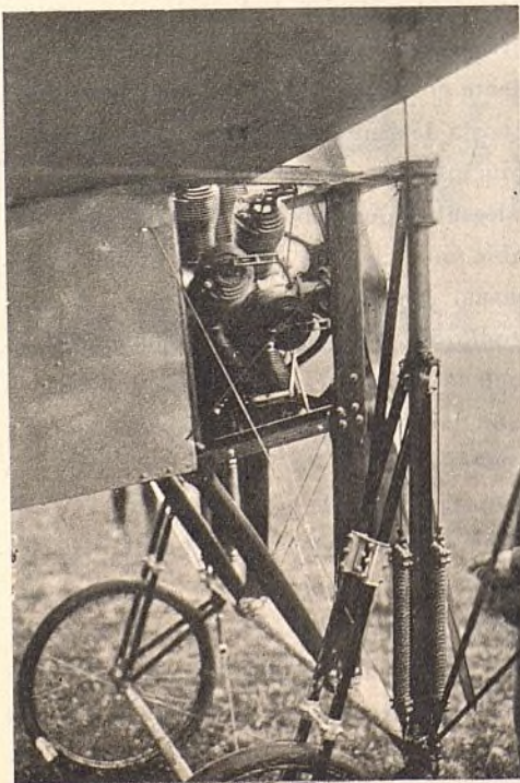
El motor de 100 HP, 14 cilindros «R. E. P.»
