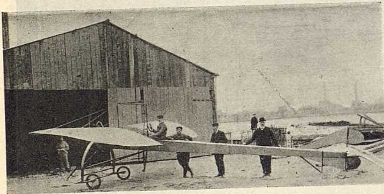
Monoplano Le Zénith , de M. Charles de Langhe. Envergadura, 8'50 m. — Longitud, 8'50 m. — Superficie, 16'2 m. — Velocidad, 70 km. por hora. — Motor «Anzani» 25 HP. — Hélice «Perfecta», de dos palas.
