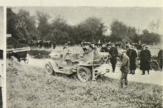
Nuevo canon automóvil para combatir contra aeroplanos y dirigibles
