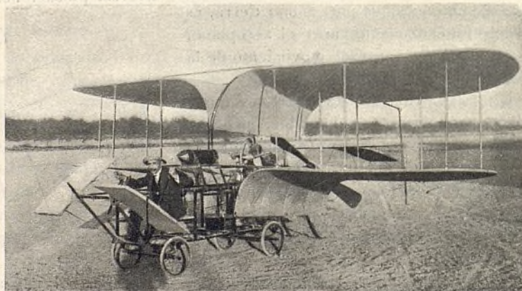
Biplano Gomes da Sylva: superficie, 25 m 2 ; longitud, 6'50 m.; peso, 250 kgs.; motor, 3 cilindros «Anzani», de 35/40 caballos
