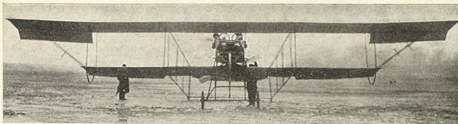
Vista total y de frente del biplano Voisin, último modelo, construido todo él con tubos de acero en sustitución de la madera
