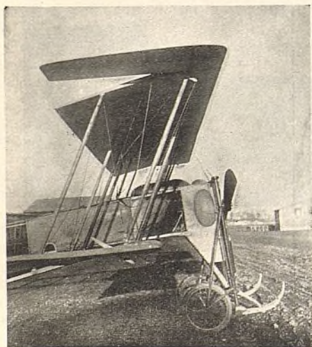
El nuevo biplano Goupy Detalle de los planos y montantes delanteros
