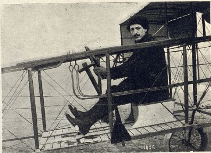
El piloto aviador Colleux, en el nuevo aparato Voisin sin cola mostrando el juego y detalles de manipulación del mismo
