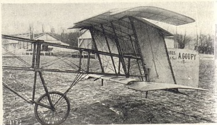
Detalles de la cola y timones de dirección del nuevo biplano Goupy
