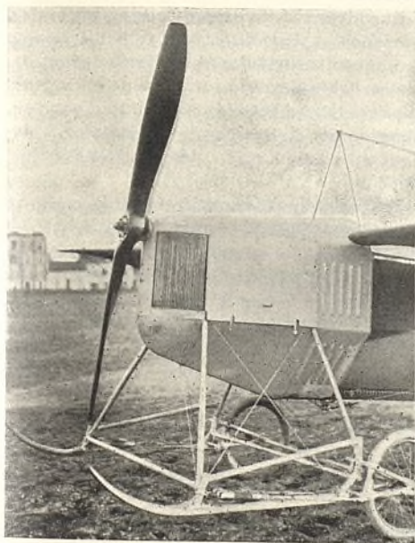
Monoplano Clément-Bayard Detalles de la parte delantera y chasis de aterrisaje
