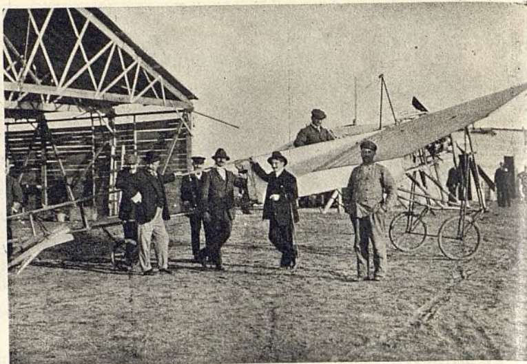
AERÓDROMO DE GETAFE. — Mr. Leforestier, con su monoplane Olga , que no logró volar por no funcionar su motor con regularidad
