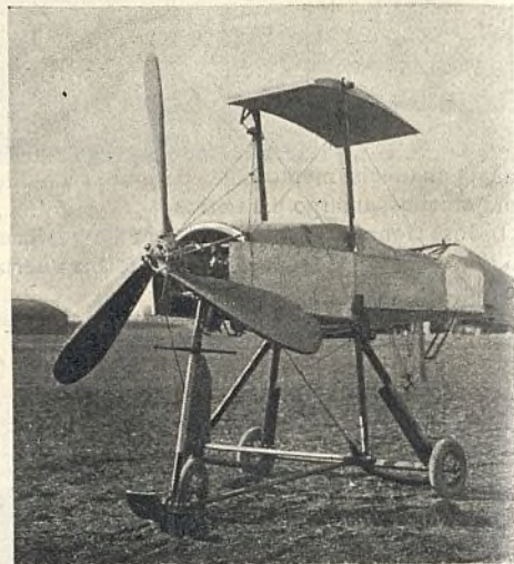
Concurso del Ministerio de la Guerra de Francia. Parte delantera del biplano Bréguet con el motor y juego de demultiplicación.
