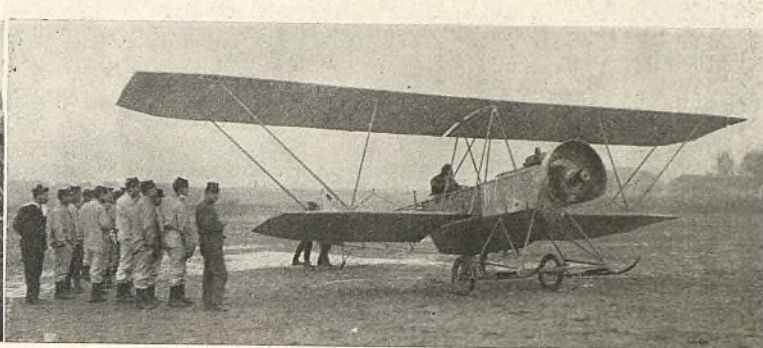
El nuevo biplano Clement Bayart , que tiene la particularidad de poderse transformar en monoplano
