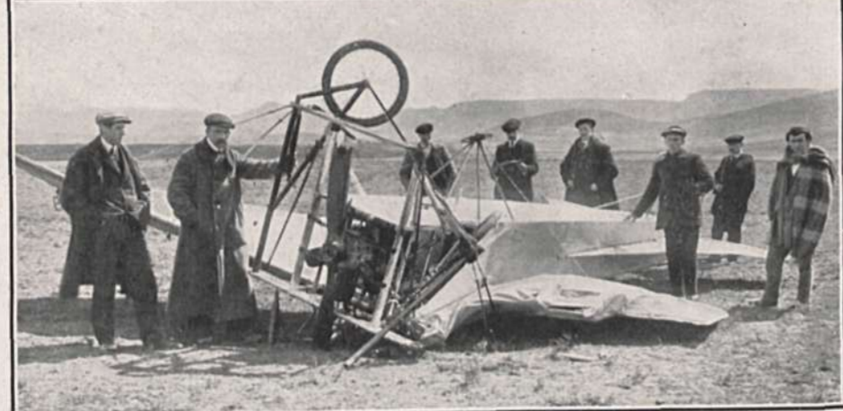
El monoplano de Mr. Garnier después del accidente sufrido por éste al realizar su primer vuelo en Pamplona. Una ráfaga de aire volcó el aparato cuando se había elevado a unos diez metros, cayendo a tierra, donde se destruyó, sin que, por fortuna, recibiera daño alguno el aviador
