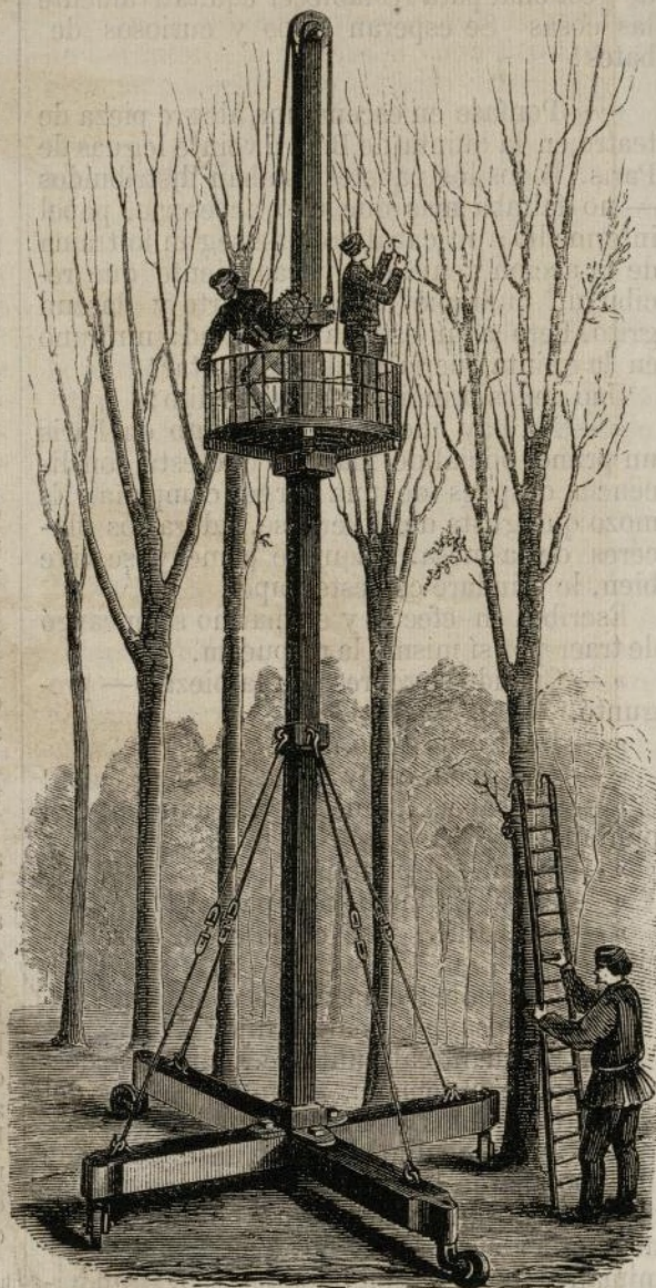
Máquina empleada para podar los árboles en el muelle de las Tullerías.
