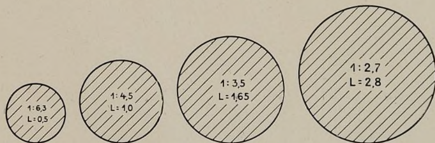
FIG. 3. — Dimensiones relativas del área del diafragma y luminosidad en las diferentes aberturas
