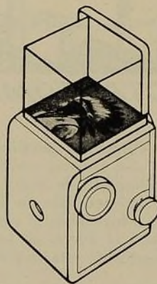
Cómo se presenta la imagen en el vidrio del visor en el dispositivo reflex.
