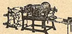
Cortadora rotativa a través para 1 tamaño, variable Q.S.M. 86
