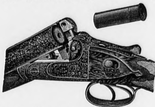
Escopeta de GREENER con expulsor automático.
