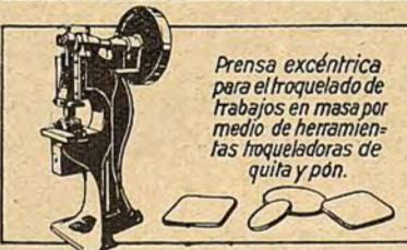
Prensa excéntrica para el troquelado de trabajos en masa por medio de herramientas hoqueladoras de quita y pón.
