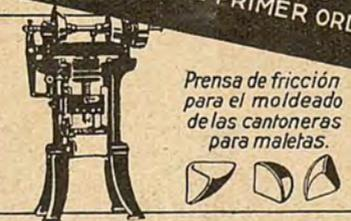
Prensa de fricción para el moldeado de las cantoneras para maletas.
