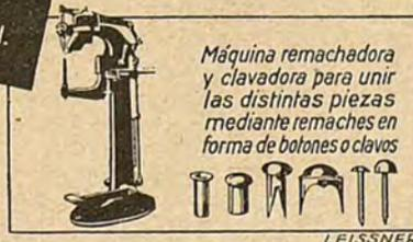
Máquina remachadora y clavadora para unir las distintas piezas mediante remaches en forma de botones o clavos
