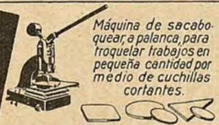
Máquina de sacaboquear, a palanca, para troquelar trabajos en pequeña cantidad por medio de cuchillas cortantes.
