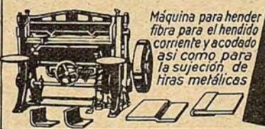
Máquina para hender fibra para el hendido corriente y acodado así como para la sujeción de tiras metálicas
