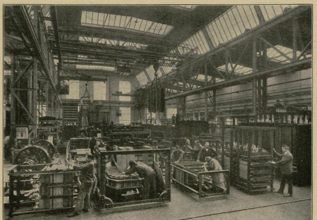
Fig. 5. Sala de montaje de transformadores gigantes.
