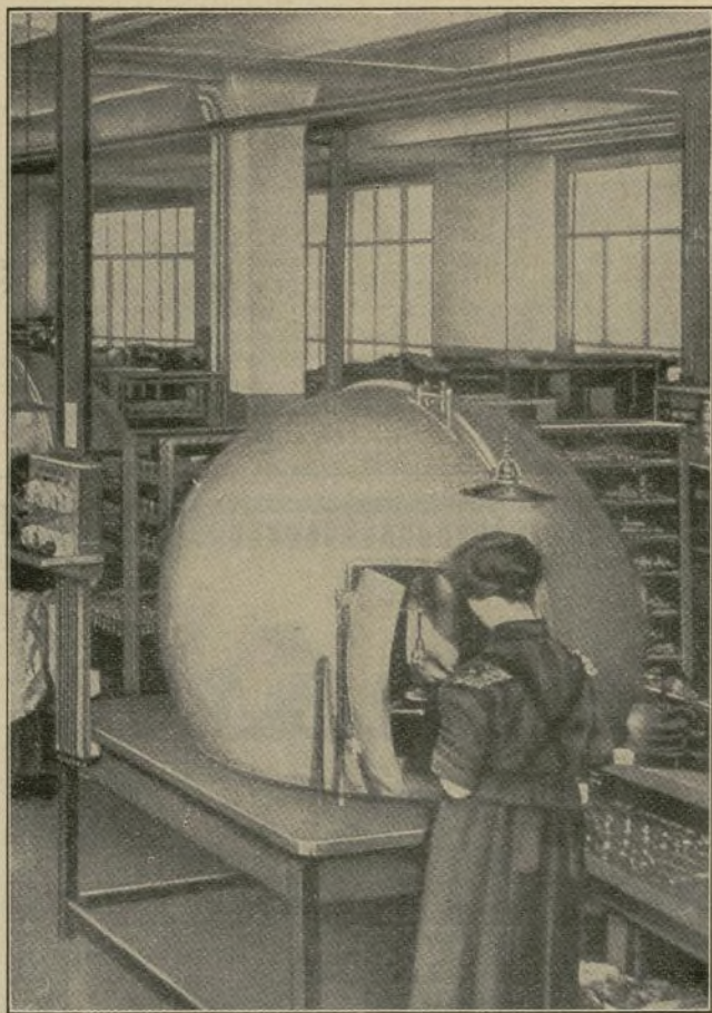
Fig. 3. Determinación del número de bujías y el consumo por bujía.
