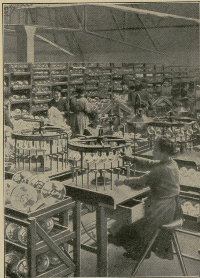
Fig. 4. Montaje del casquillo en la lámpara llena de gas.
