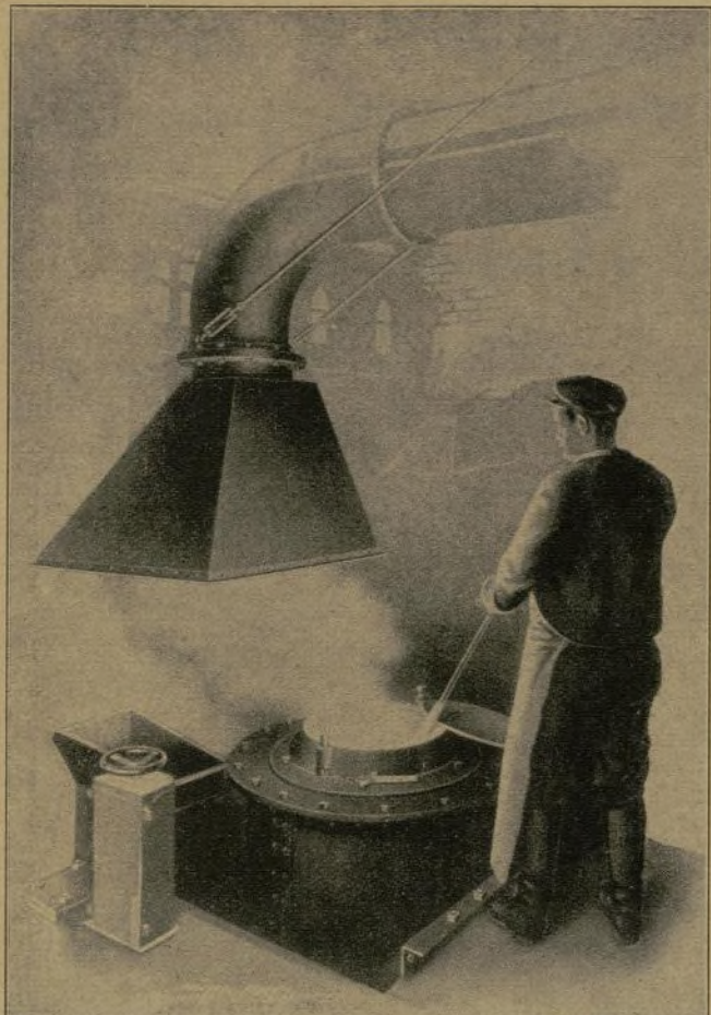
Eliminación de las escorias de un horno Ajax poco antes de efectuar la colada.
