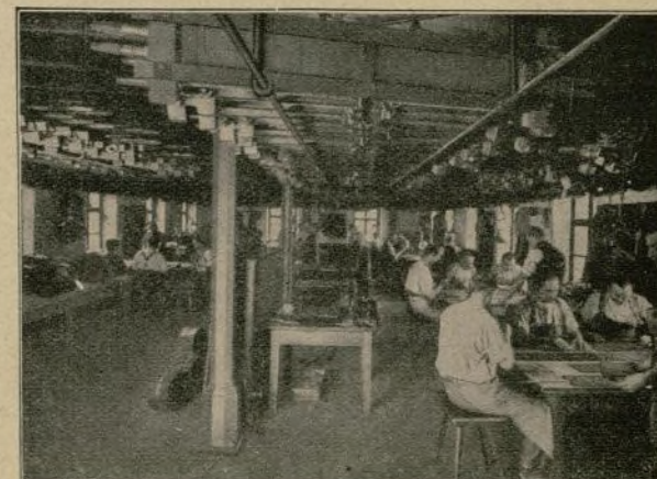
Sala de pegar tablitas de minas de lápices con cola.
