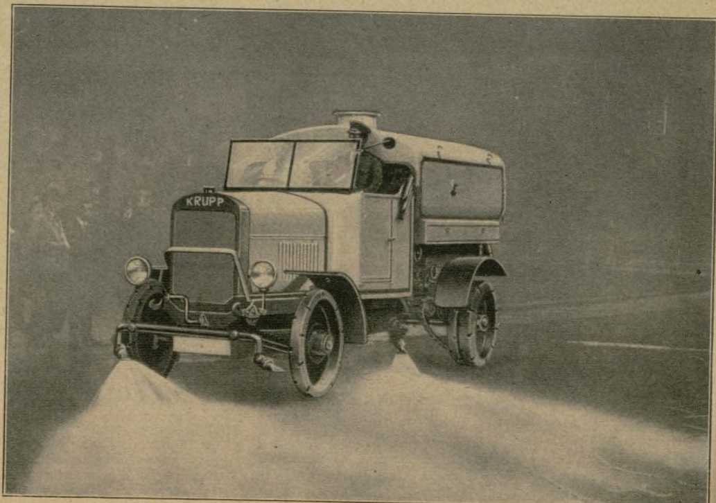
Regadera automovil para lavar las calles con dispositivo de riego de grande alcance.
