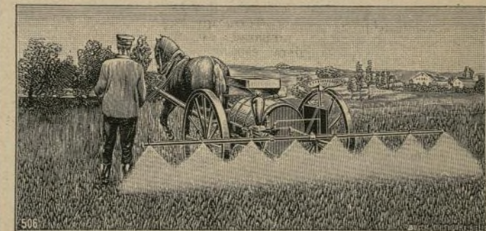
Jeringa «Hederichtod» para la pulverización de soluciones de sulfato de hierro, destructor de hierbas malas. (H. C. Fricke, Bielefeld)
