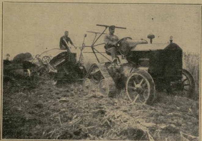
Tractor con orugas desmontables remolcando una guadañadora-atadora.
