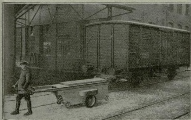
Fig. 3. Tractor de un solo eje remolcando un vagón Sistema Gottwald Müller, Berlin-Karlsborst
