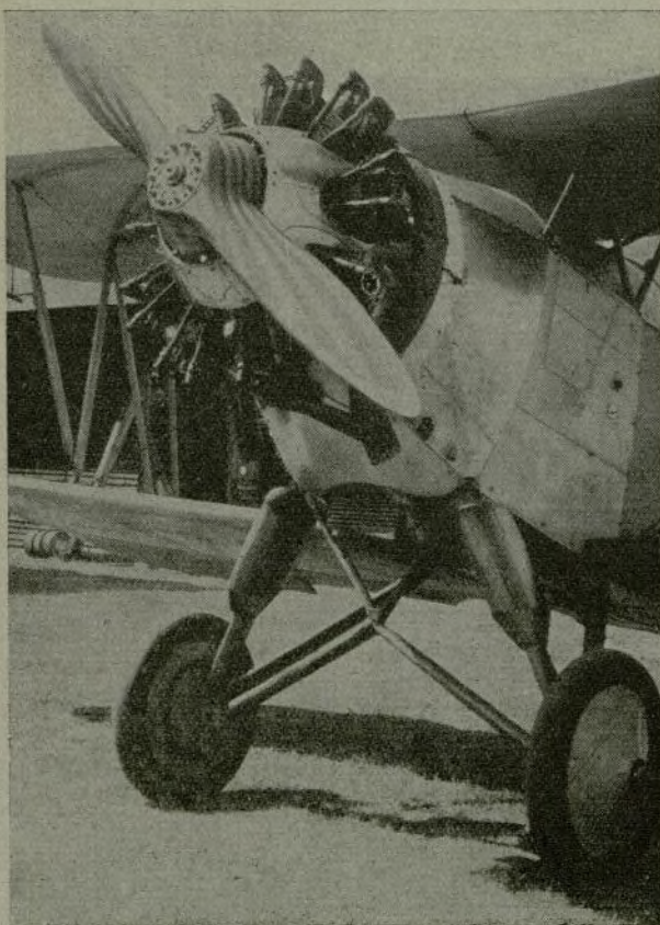
Biplano "Heinkel" con motor Siemens Sh. 20
