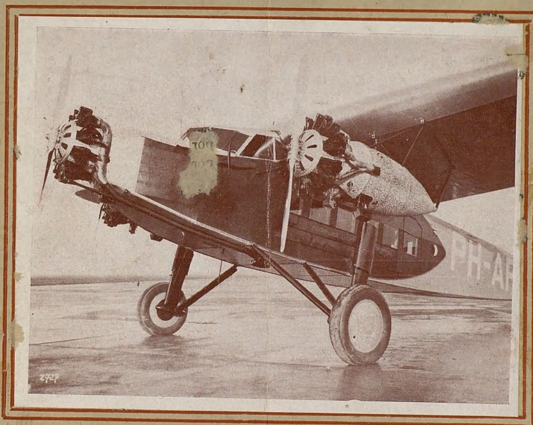
Ultimo modelo de avión de pasajeros Fokker tipo F. XII con tres motores Wasp de 400 c. v. cada uno. La cabina tiene capacidad para 16 pasajeros. Este tipo de aviones se emplea en el servicio regular entre Amsterdam y Batavia, en una línea de 14.000 kilómetros
