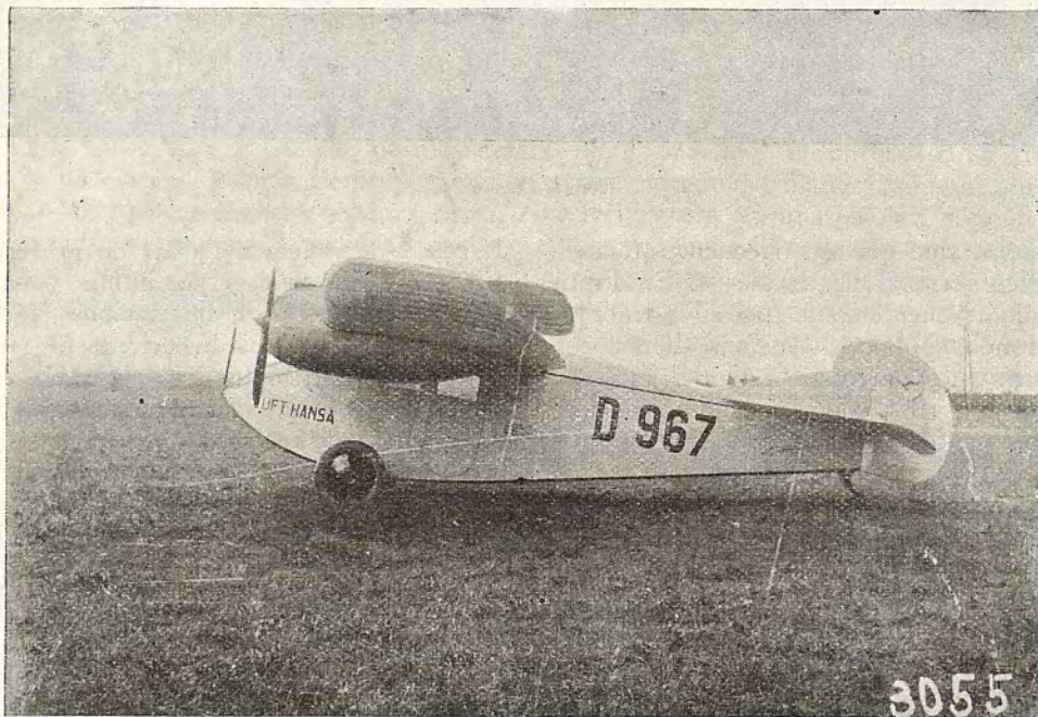
El «Focke Wulf» bimotor para el entrenamiento de pilotos en aviones multimotores.
